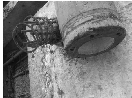
写真2 引き抜かれた杭の先端部 (No.1)
