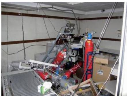
写真1 高圧ガスボンベの被害
