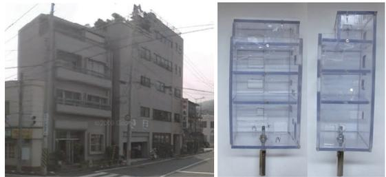
図-7 塩化ビニール樹脂製の建物模型 (左: Google Earth, 右: 陸側正面 (左) と南側側面 (右))
