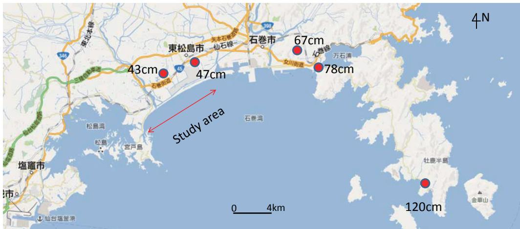
図-6 国土地理院による地盤沈下の実測値
