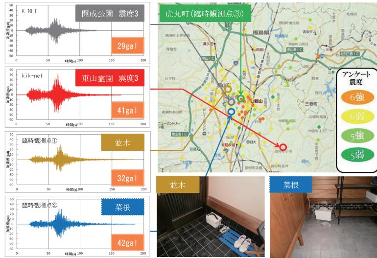
図-5 臨時及び既設観測点における余震記録 EW 成分の加速度波形と
