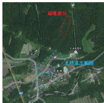
図-3 崩壊部分と土砂流出範囲 (Google mapに加筆)
