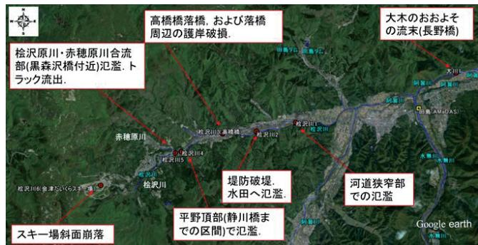
図3 桧沢川被害概況平面図
