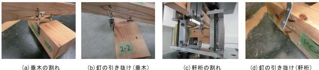
図4 破壊性状の分類
