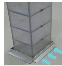
図-4 模型と低鉛直壁設置例(全周型)
