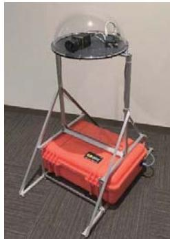
図-1 独立電源型観測装置
