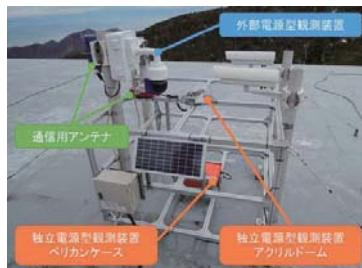
図-7 観測装置の設置状態
