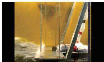
図8 橋の固定棒（強化対策後）
