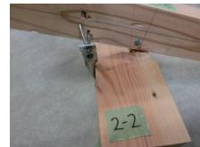
図4 ひねり金物を用いた接合でみられた
