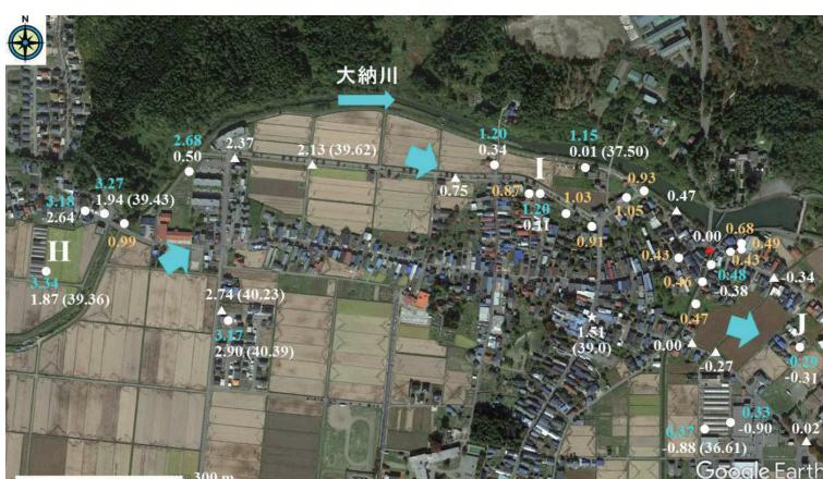
図-6 横手市大森町地区における左支川大納川の外水と内水の氾濫による最大浸水痕跡水位などの空間分布（Google Earthに加筆、一部を除き、凡例は図-4と同じ）。本地区で確認できた最大浸水深は218 m。
