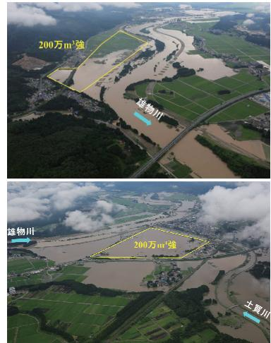
図-7 大仙市峰吉川地区(上図)と刈和野地区(下図)における最大貯留量評価域(国交省提供写真に対象域を加筆)
