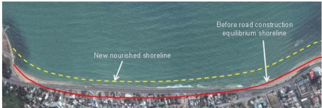
図-8 養浜による形成される汀線形状
