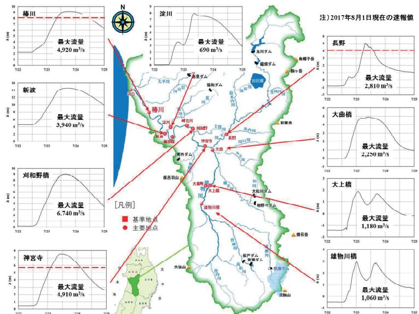
図-3 雄物川流域とその主要地点における今回降水のハイドログラフ（国交省の流域図<sup>2</sup>と国交省・秋田県の水位データ<sup>1)</sup>を利用）
