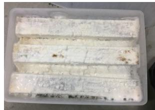
図 7 強制腐朽させた試験体
