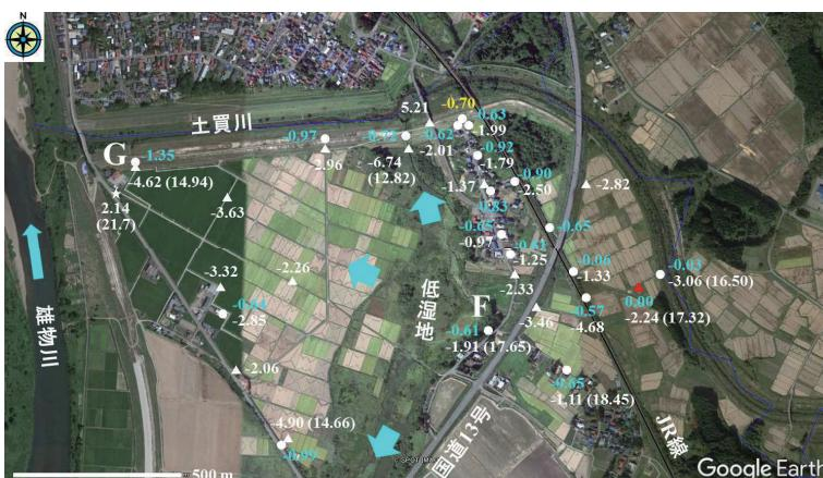
図-5 大仙市刈和野地区における右支川土買川の外水と内水の氾濫による最大浸水痕跡水位などの空間分布（Google Earthに加筆。凡例は図-4と同じ）。本地区で確認できた最大浸水深は6.02 m。
