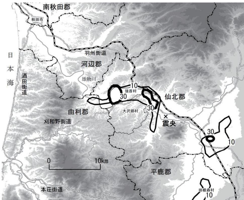
図1 1914年秋田仙北地震の被害分布と秋田市（数字は住家全壊率%）
