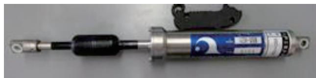
写真 1 流向流速計 (No.104)
