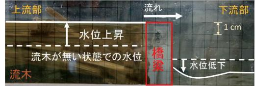
写真-2 橋梁模型の横方向からの流木堆積の様子
