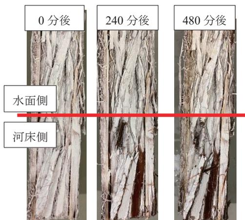
図 18 剥離状況（土砂-側面 2）
