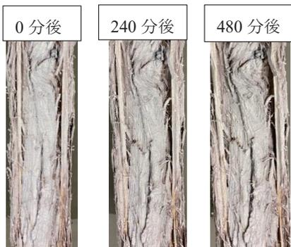
図8 剥離状況(清水-側面1)
