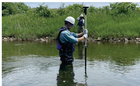
図-2 RTK 測量の様子
