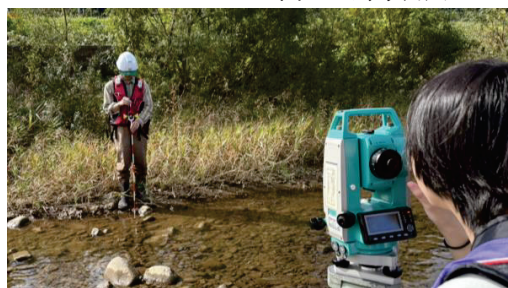
図-3 光波測量の様子
