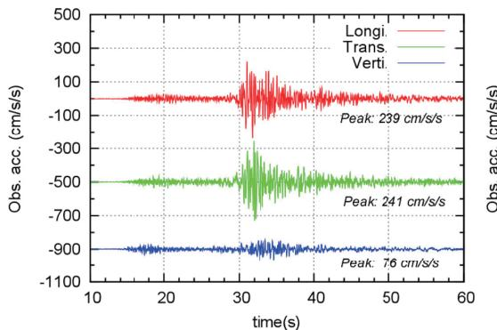
図8 7月24日に岩手県沿岸北部で発生した地震の加速度記録。左が1階、右が3階。
