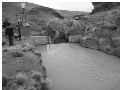
写真-3 Tuni bajo 観測所（流量堰と気象観測機）
