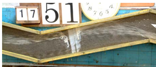
図-9 固定堰上流に局所洗掘を発生する場合の水表面流跡線（堰位置⑭，散布パンチ屑流し撮り t=1/10 秒） 初期砂均し高：上流0mm 下流-6mm(Q=0.6L/s)
