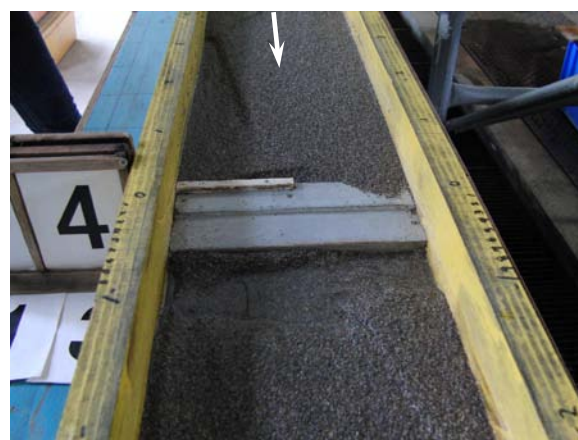
図-7 段落ち流による可動堰敷上堆砂の掃流 初期均し高：上流0mm 下流-3mm ( Q=0.6L/s )
