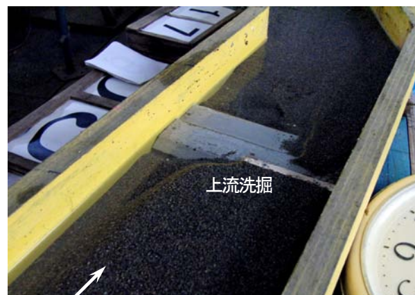
図-10 可動堰部上流河床の局所洗掘（堰位置⑥） 初期砂均し高：上流0mm 下流-6mm(Q=0.6L/s)
