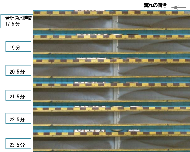
図-5 砂礫堆の移動による砂床形状変化 初期砂均し高：上流0mm 下流-3mm ( Q=0.6L/s )
