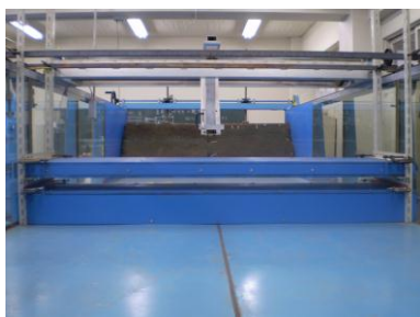
写真-3 水平板と潜堤の模型 (造波装置側から撮影)
