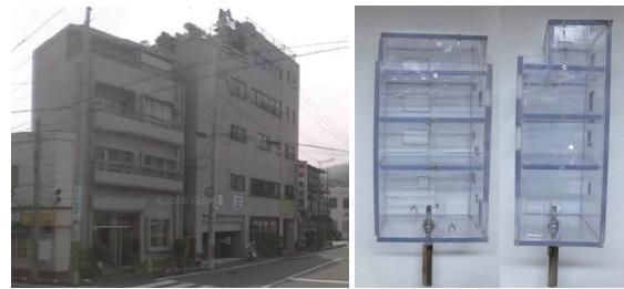
図-7 塩化ビニール樹脂製の建物模型（左：Google Earth, 右：陸側正面（左）と南側側面（右））
