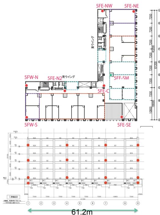
図3 災害科学国際研究所新棟の計測点
