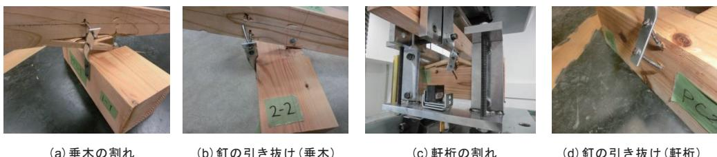
図4 破壊性状の分類
