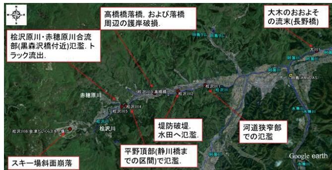
図3 桧沢川被害概況平面図
