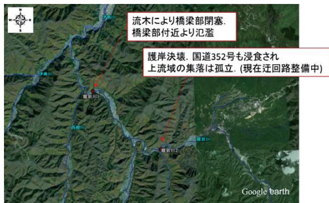
図4 館岩川被害概況平面図
