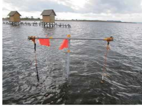
写真2 計測機器設置完了後の様子 左側下：流向流速計 右側下：水温塩分計
