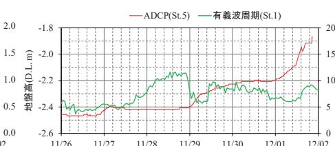
図-2 有義波高（左）および有義波周期（右）と砂面高の経時変化
