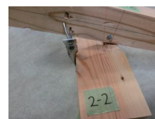
(b) 釘の引き抜け
