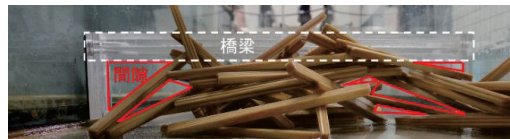
写真-4 流木が49本堆積した状態
