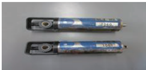
写真2 使用した小川原湖漁協の水温塩分計 (No.1060, 1061)
