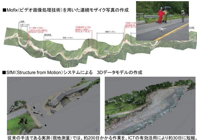
図-5 測量に関わる新技術の適用 (北海道開発局資料<sup>1)</sup>)
