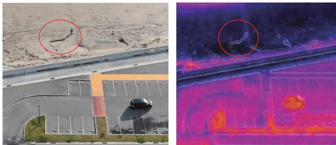
図7 ドローンに搭載した可視光線(左図)/赤外線(右図)カメラでの残存者観測
