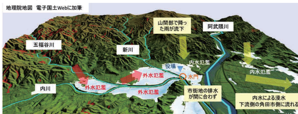
図3 丸森地区平野部と館矢間地区の水害の被災状況
