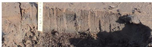
写真-1 千曲川の破堤氾濫域のSt.6における堆積土砂の層構造 (地表から泥層[22 $\mu$ m]+砂層[225 $\mu$ m]+泥層[53 $\mu$ m]の3層)
