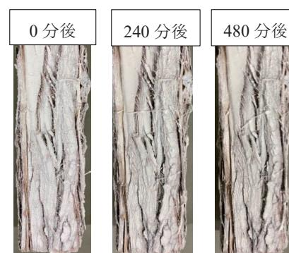
図9 剥離状況（清水-側面2）
