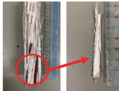
図 19 側面 2 の剥離した樹皮（150 分後）
