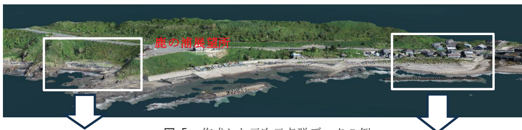
図-5 作成した三次元点群データの例
