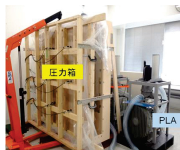
図5 金属サイディングの載荷試験
