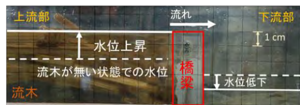
図-2 横方向からの流木堆積の様子
