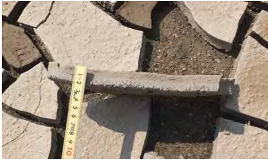
図-2 St.9における堆積土砂の断面構造（砂層＋泥層）
