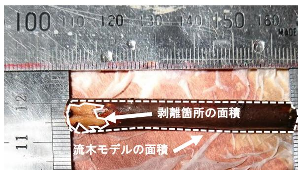
図-2 流木モデルの樹皮剥離
