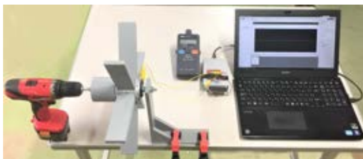
図 1 モーターの測定系
