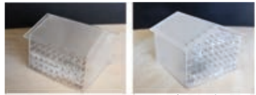
(a) 桁行面測定用 (b) 妻面測定用
