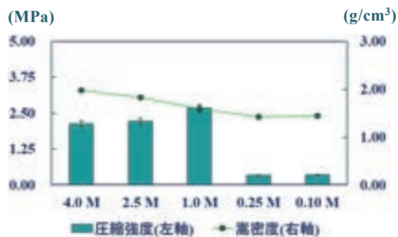
Fig.4 試料の圧縮強度と嵩密度
